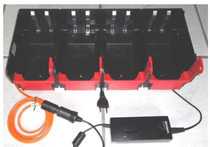
Ladebox mit 12 / 24 Volt Fahrzeugstecker (links) (Oder optional: mit 230 Volt Netzladegerät, rechts)
