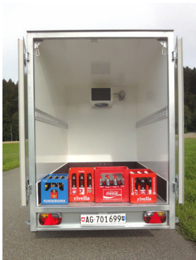
Innenansicht des Kühlaufbaus: mit 240 x 140 x 180 cm ist der Anhänger sehr geräumig
