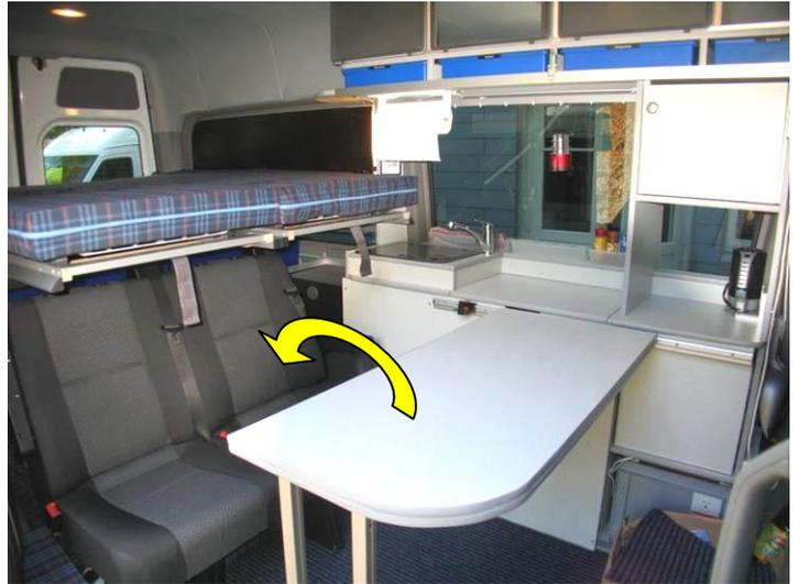
Ansicht von der Seite: Aufklappbarer Esstisch für 4 Pers. (Fahrer- und Beifahrersitz sind drehbar). Küche mit Kühlbox (50 l) und Brünneli mit Kalt- und Warmwasser.
